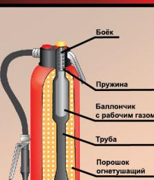
Устройство имеющее заряд огнетушащего вещества со встроенным источником давления (газовый баллон) в режиме ожидания находится без давления.
